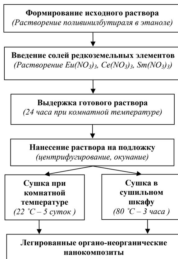
Рис. 1. Схема получения нанокomпозитных материалов, легированных редкоземельными элементами
