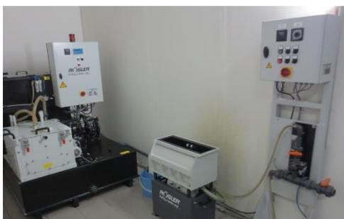
Рис. 2. Виброгалтовочная установка лоткового типа
