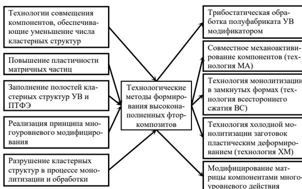
Рис. Технологические методы получения высокопрочных износостойких фторкомпозитов с повышенным содержанием углеродного наполнителя (УВ)
