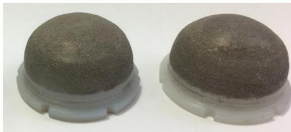
Рис. 1. Внешний вид металлополимерных чашек эндопротеза тазобедренного сустава
