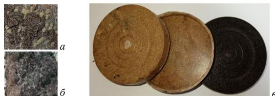
Рис. 2. Образцы БКМ: с ДО (а), ГЛ (б) после компостирования. Образцы сформованных изделий из наполненного ПЛА (в)
