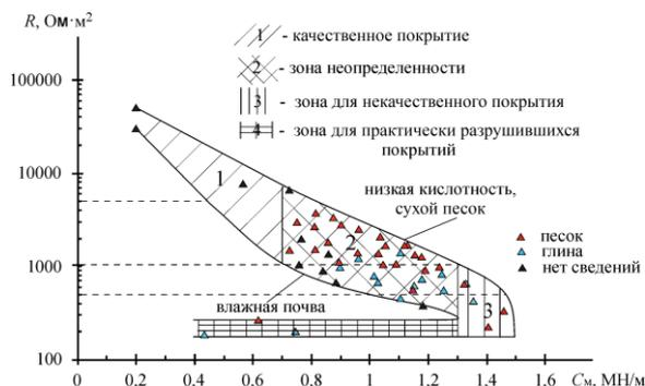
Рис. 2. Связь переходного электросопротивления и жесткости покрытия
