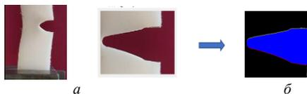
Рис. 1. Стоп-кадр развития трещины в образце СВМПЭ (а) и результат его программной обработки (б)
