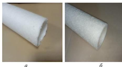
Рис. 2. ВПМ в виде картриджей из ПЛА FY 201: а – с применением односопловой головки; б – многосопловой головки
