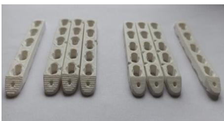
Рис. 1. Полимерные пластины, полученные 3Д-печатью
