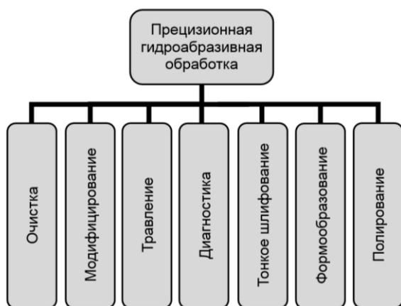
Рис. 1. Классификация процессов прецизионной обработки поверхности, в основе которых используется явление гидроабразивного изнашивания
