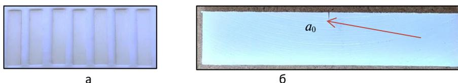
Рис. 1. Вид образцов для проведения испытаний на трещиностойкость: а – до надреза, б – после надреза
