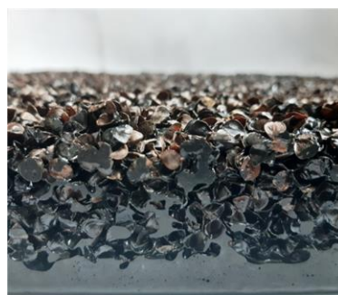
Рис. 1. Структура акустического композита на основе гречневой лузги и модифицированной эпоксидной смолы
