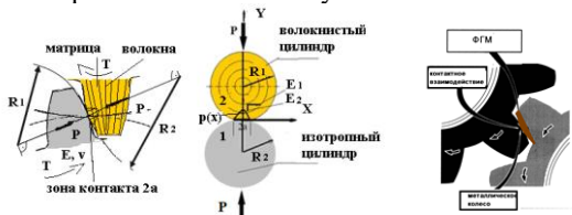
Рис.1. Пример схемы контакта двух зубьев зубчатой передачи из изотропного и композиционного материалов и с покрытием, E_1, E_2 – модуль упругости волокнистого цилиндра
