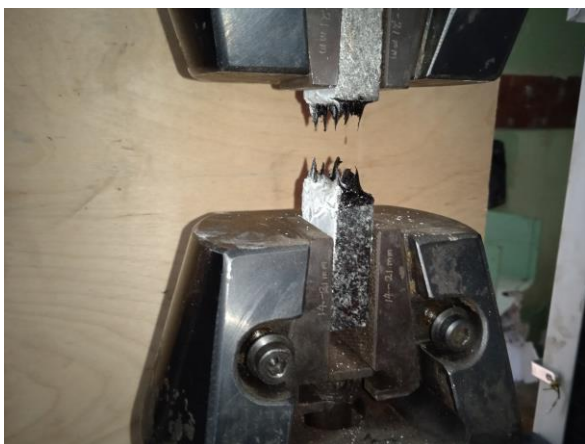
Рис. 1. Проведение эксперимента на испытательной машине WDW-100E
