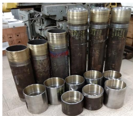
Рис. 1. Фото натуральных образцов ниппелей НКТ и соединительных муфт с покрытием на резьбовых поверхностях
