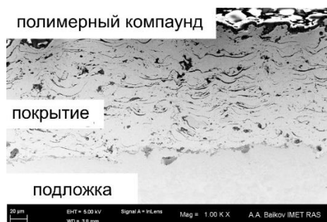
Рис. 1. Структура покрытия на основе никеля
