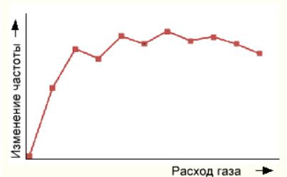
Рис. 1. Зависимость скорости роста покрытия от давления (расхода газа)
