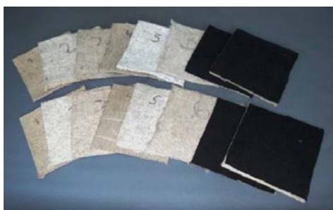
Рис. 1. Разработанные звукопоглощающие композиционные материалы
