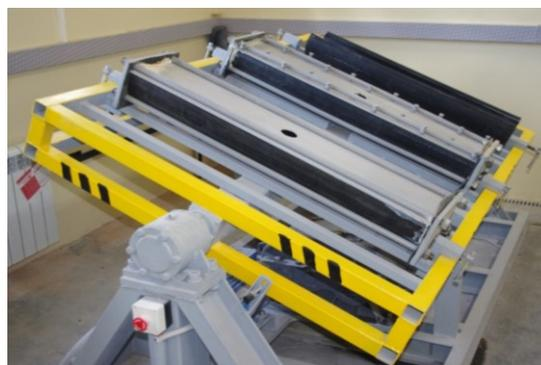
Рис. 1. Установка для определения износа труб по методу EN 295-3:2012 часть 3 п. 15
