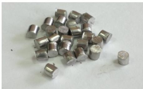
Рис. 1. Внешний вид плавких вставок
