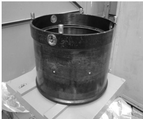
Рис. 1 Корпус размерностабильной конструкции космического назначения
