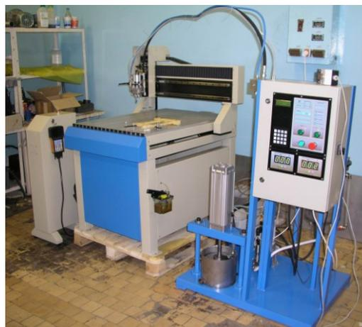
Рис. 1. Комплекс оборудования для нанесения уплотнительных герметиков по заданному контуру
