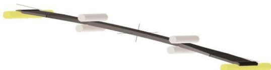
Рис. 1. Профилированная балка-рессора
