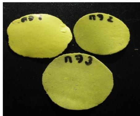
Рис. 1. Фотографии полученных образцов на основе полиэтилена ПЭВД с наполнителем — наноструктурированным порошком  $\text{Y}_3\text{Al}_5\text{O}_{12}:\text{Ce}$ : ПЭ1 — 10 мас.%, ПЭ2 — 20 мас.%, ПЭ3 — 30 мас.%
