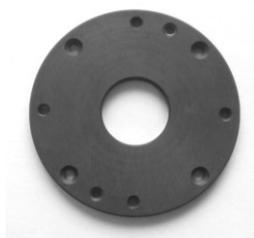
Рис. 1. Диск с МДО-покрытием для проведения испытаний
