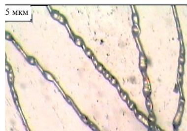
Рис. 1. Микрофотоснимок крейзованных ПЭТ волокон
