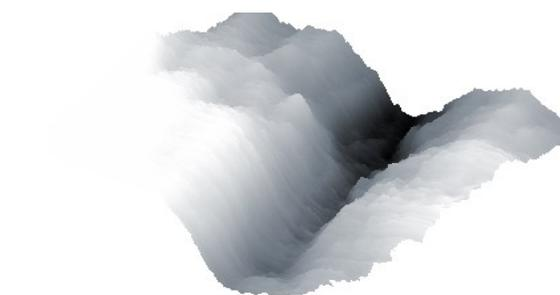
Рис. 2. Топография поверхности алмаза после шлифования: *a* — профиль высот поперек борозды (в); *б* — профиль высот вдоль борозды (в); *в* — трехмерное изображение площадки
