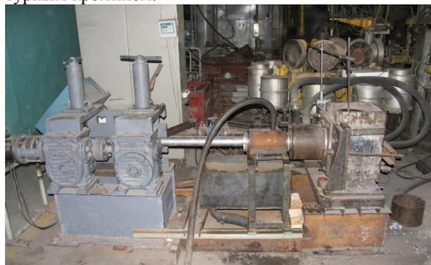
Рис. 1. Установка непрерывного горизонтального литья
