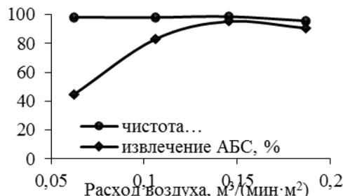
Рис. 2. Зависимости чистоты концентрата и извлечения АБС от расхода воздуха при количестве смеси ПАВ 0,5 мл/м³
