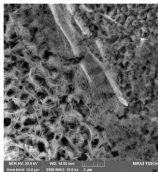
Рис. 2. Микрорельеф композитного покрытия цинк-никель-оксид-полимер
