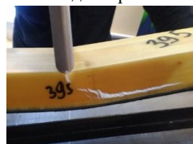
Расслоение древесины и смятие под индентором
