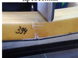
Разрыв и смятие в шиповом соединении
