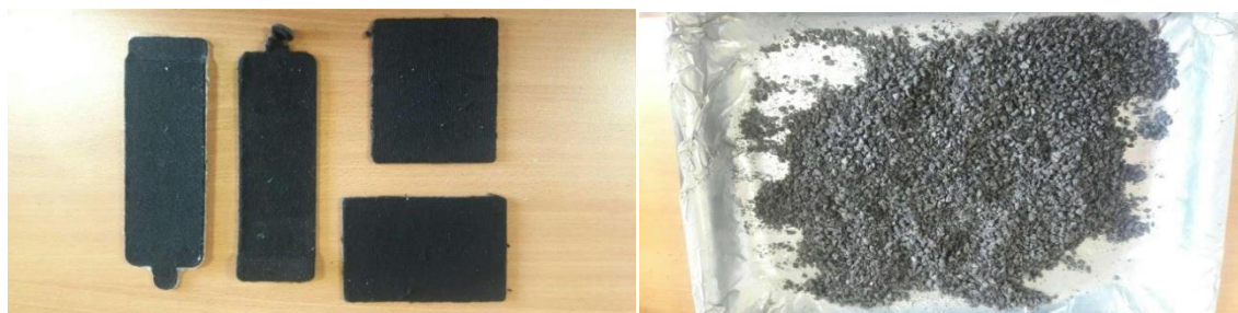
Рис. 1. Отходы листового полипропилена: исходные (слева) и после отделения полиэфирной ткани и измельчения (справа)
