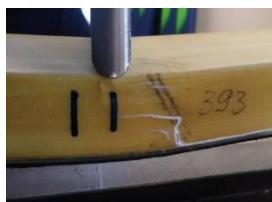
Разрыв в зоне шипового соединения, расслоение древесины и смятие под индентором
