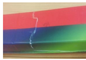
Разрыв в шиповом соединении, расслоение древесины
