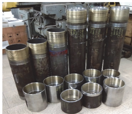
Рис. 1. Фото натурных образцов ниппелей НКТ и соединительных муфт с покрытием на резьбовых поверхностях
