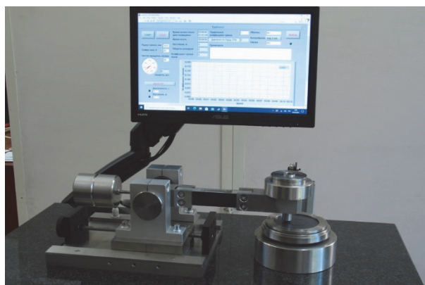
Рис. 1. Трибологический стенд Триботест
