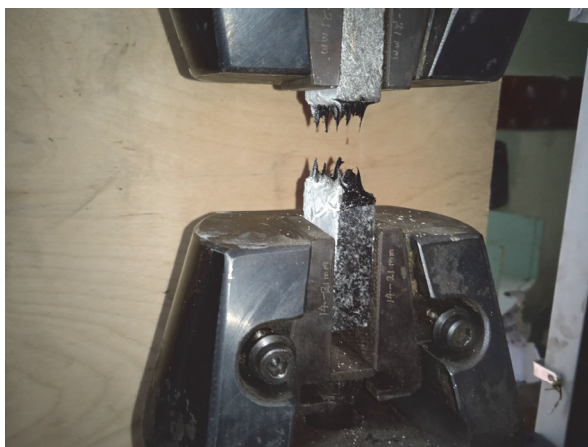
Рис. 1. Проведение эксперимента на испытательной машине WDW-100E
