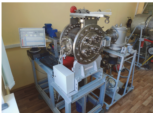
Рис. 1. Трибологический вакуумный стенд «ВС-01»
