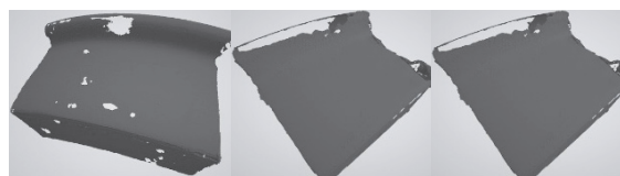
Рис. 2. Трёхмерная модель образцов бандажей
