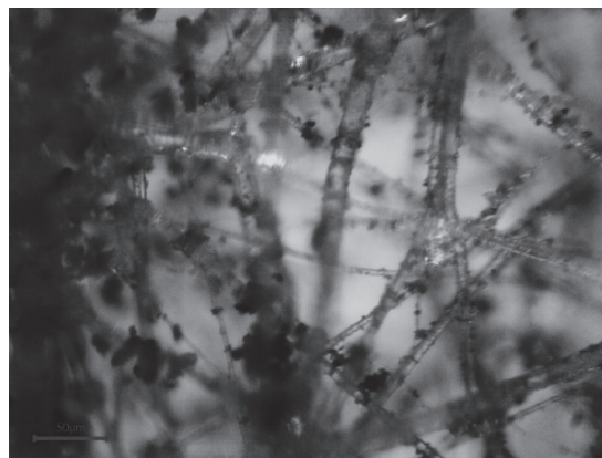
Рис. 1. Структура первичного фильтрующего слоя с задержанными частицами загрязнения
