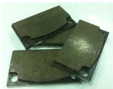
Рис. 1. Внешний вид тормозных накладок
