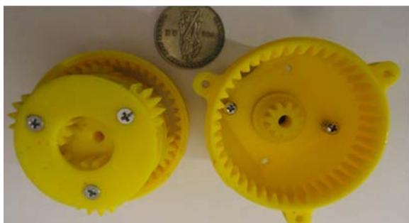
Рис. 1. Двухступенчатый планетарный редуктор со снятой крышкой
