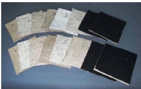
Рис. 1. Разработанные звукопоглощающие композиционные материалы
