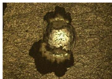
Рис. 2. Выкрашивание покрытия при амплитуде 200 мкм
