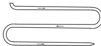
Рис. 1. Схематичное изображение трубчатых реакторов, в которых проводилась эксперименты по ФП
