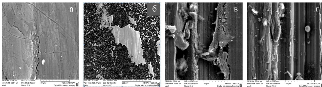
Рис. Морфология поверхности износа: а — матрицы композиционного материала; б — поликристалла; в, г — стали. Продолжительность обработки, минут: в — 3; а, б, г — 5
