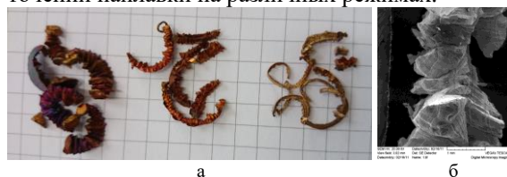
Рис. 1. Форма стружки при точении наплавки резцом Т15К6 (а) — v = 2,6 м/с, t = 1 мм, S = (справа налево 0,12, 0,25, 0,6 мм/об), (б) — вид стружки с боковой стороны
