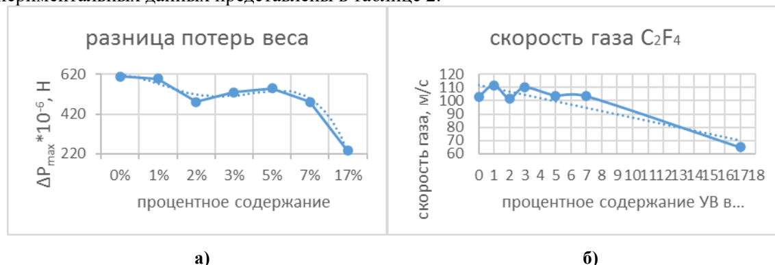
Рис. 2. а) График разницы потерь веса от процентного содержания УВ в ПТФЭ; б) график скорости вылета газа при ЛА от процентного содержания УВ в ПТФЭ.
