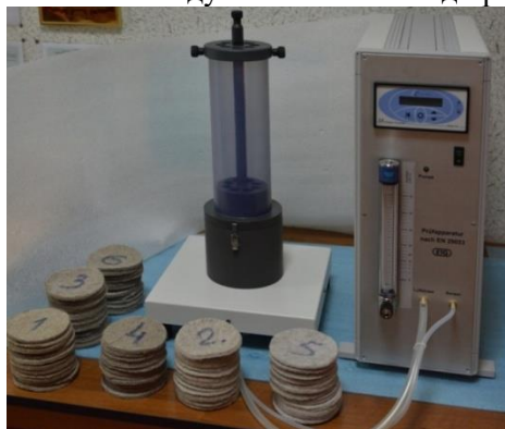
Рис. 1. Внешний вид прибора РА-SW для определения коэффициента сопротивления продуванию потоком воздуха
