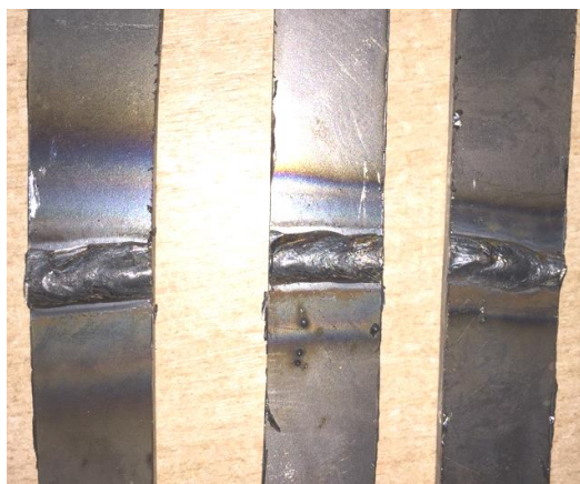
Слева-направо: без охлаждения, охлаждение с соплом 1 мм, охлаждение с соплом 2 мм
