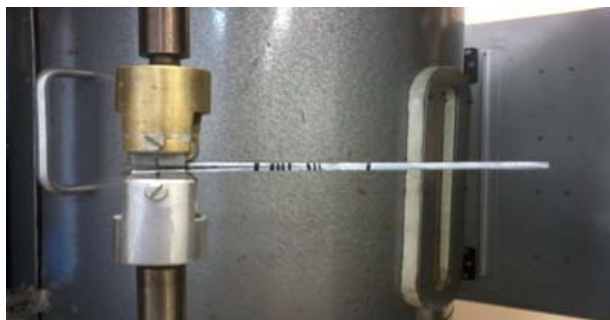
Рисунок 1 – Образец углепластика для испытания межслоевой вязкости разрушения
